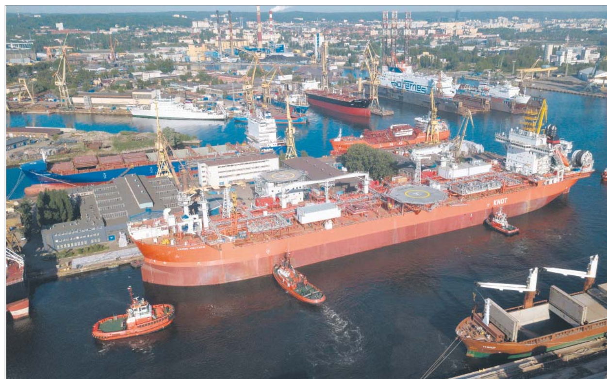
♦ Tankowiec wahadłowy Hanne Knutsen przebudowany na jednostkę FSO
