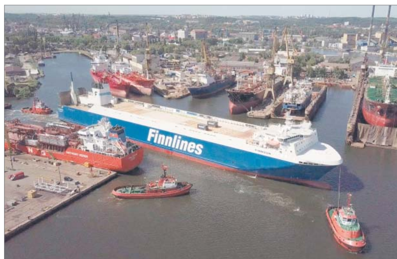
◆ Dłuższy o 30 metrów Finnsun - jeden z sześciu statków ro-ro przedłużanych w Gdańskiej Stoczni Remontowa SA
