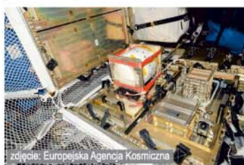
Widoczna biała kapsuła zawierająca systemy łączności statków kosmicznych, która jest zdolna do przetrwania lotu z kosmosu na Ziemi i wodowania w Południowym Pacyfiku, dla której są opracowywane nowe anteny i technologia ich produkcji, którą wdroży PIT Radwar z PGZ.
