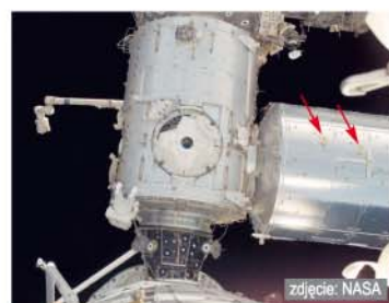
Po prawej stronie widoczne na kadłubie dwie anteny opracowane i wykonane pod kierunkiem Pawła Kabacika we współpracy z Airbus Space&Defence, Boeing Integrated Defence Systems, ESA, NASA i blisko dziesięć firm z Polski, Europy i USA. Zdjęcie wykonane podczas prac w otwartej przestrzeni kosmicznej astronautów Międzynarodowej Stacji Kosmicznej.
