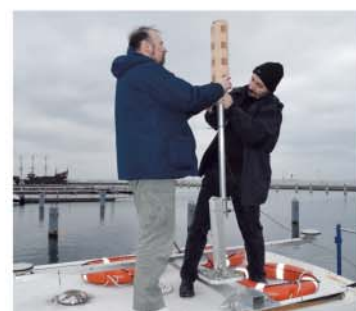
Przygotowanie w Gdyni do testów morskich jednej z anten opracowywanych wspólnie z Norwegią dla nowych rozwiązań szerokopasmowych łączności radiowych pomiędzy statkami i lądem. Widoczna na zdjęciu antena, wcześniej przesłana dwuletnie testy radiowe na redzie singapurskiego portu.
