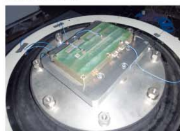
Pokładowy nadajnik i części komputera 45kg minisatelity ESEO Europejskiej Agencji Kosmicznej, który za rok poleci w kosmos. Zdjęcie z realizacji jednego z prawie stu testów formalnej procedury kwalifikacji do lotu w kosmos.
